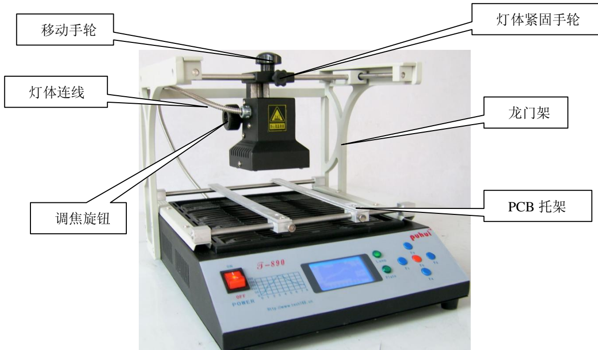
图 4-3: 焊台龙门架和灯体
