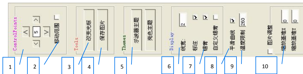
1: 控制点移动方向 2: 部分/全部移动控制点 3: 改变放置控制点光标 4: 保存客户区图片 5: 设定主题 6: 回流曲线线宽 7: 客户区各项显示/隐藏 8: 是否平滑曲线 9: 温度超限保护 10: 编辑打开的图片
