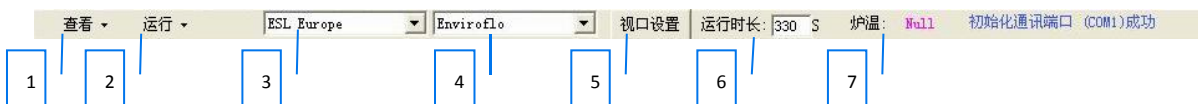
1: 查看机器存储曲线 2: 运行机器存储曲线 3: 锡膏品牌 4: 锡膏型号 5: 重设视口大小 6: 焊接周期设置 7: 当前炉温
